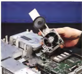
La struttura che ospita le ventole a velocità fissa ed il processore allungando il raso di disposizione delle quattro inguente per la connessione elettronica con il socket sulle mother board
